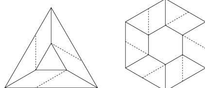
図 10 正三角形、正六角形のねじり折りの基本パターン。
