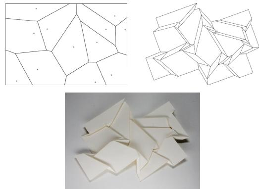
図 13 ランダムな点群から生成したボロノイ図（左上）、各多角形を 30% 縮小させて 20 度回転させて作った展開図（右上）、展開図を折りたたんだ様子（下）。
