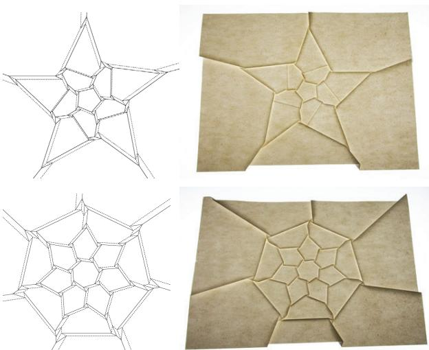
図15 提案システムで設計した折紙。展開図（左）と、折った後の写真（右）
