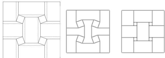
図 9 図 8 のねじり折りを 4 つ連結したパターン。左から展開図、表面、裏面。
