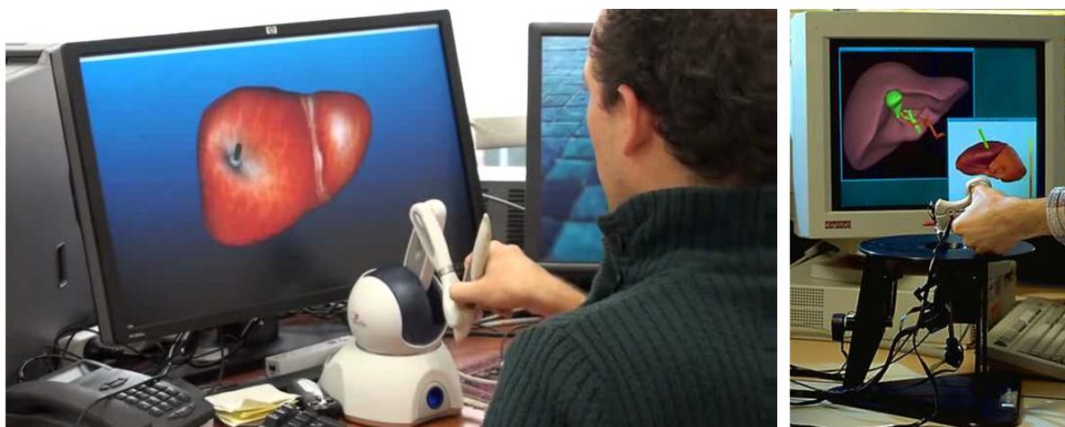
図 1-1 ハプティックデバイスを鉗子として用いている手術シミュレータ (左図:画像出典: [2], 右図: INRIA hepatic surgery simulator 画像出典: [3])
